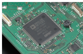
メインIF DSP、送信部用 ADSP-21363 clock @333MHz
