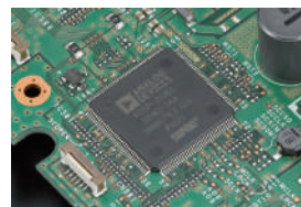
バンドスコープ用 ADSP-21363 clock @333MHz
