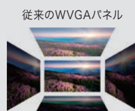
従来のWVGAパネル 見る角度によって 明るさが変化してしまふ。
