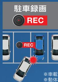
車載電源ケーブルCA-DR100 (別売) を使用して、24時間365日、駐車中にフロントカメラに内蔵のGセンサーが振動を検知すると、ドライブレコーダーが起動して前後2台のカメラで撮影した映像を記録(1ファイル60秒)。その後、駐車録画フォルダに保存します。微小な暗電流を使用するためバッテリーへの負担を抑えます。
