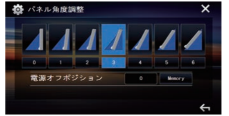
視野角調整機能+7段階スライドパネル機構
