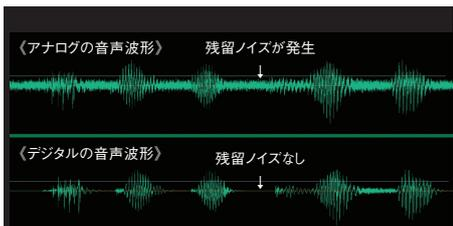
《上図》アナログでは残留ノイズにより音声埋もれ、聞き取りにくくなります。
