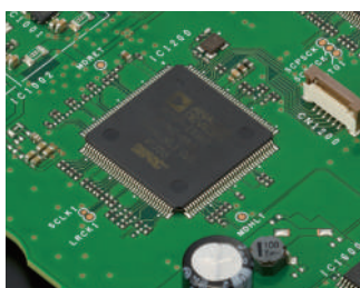
IF DSP、送信部用 ADSP-21363 clock @332MHz
