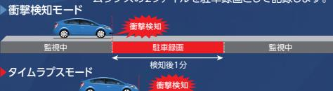
※バッテリー保護のためバッテリー電圧が低下した場合、車載電源ケーブルでタイマー設定した時間よりも早く駐車監視機能が停止することがあります。
