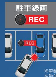
車載電源ケーブルCA-DR100(別売)を使用して、24時間365日、駐車中にフロントカメラに内蔵のGセンサーが振動を検知すると、ドライブレコーダーが起動して前後2台のカメラで撮影した映像を録画(1ファイル60秒)。その後、駐車録画フォルダに保存します。微小な暗電流を使用するためバッテリーへの負担を抑えます。
