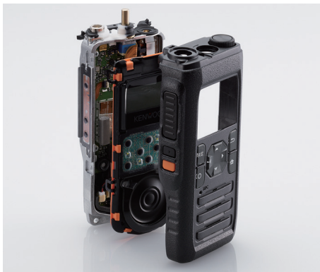
防塵/防水/衝撃/歪に強い2重構造
